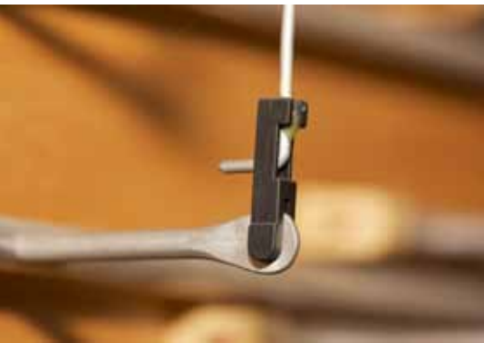
Über solche Hebel und Züge werden die Ventile der Pfeifen betätigt.
